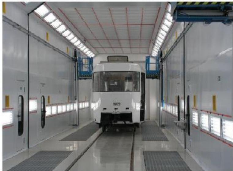
شکل ۶- اتاق رنگ آمیزی (Painting Cabinet) برای انواع واگن
