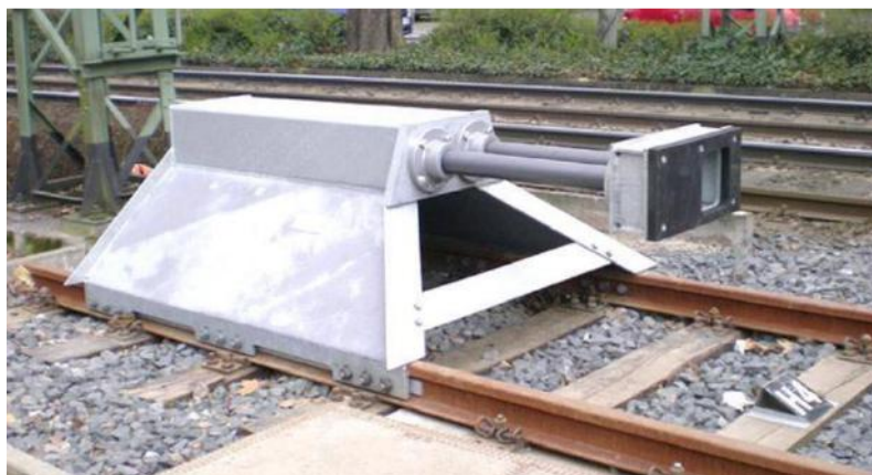
شکل ۱۰- نمونه ای از بافر استاپ های ثابت با سیستم جاذب هیدرولیکی
