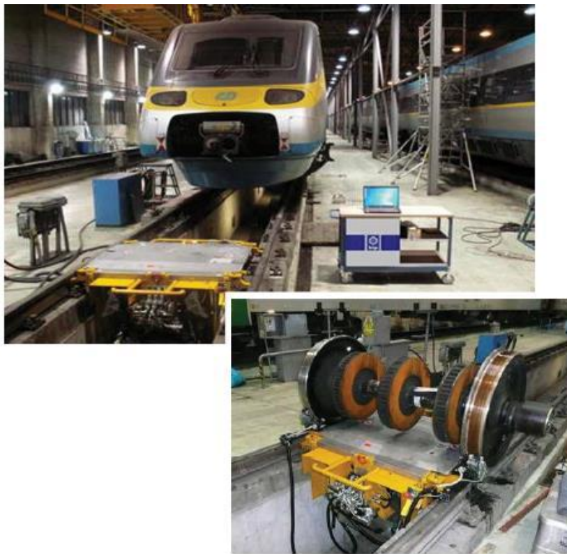
شکل ۹- دستگاه زیر سطحی التراسونیک اندازه‌گیری ساختار چرخ و محور
