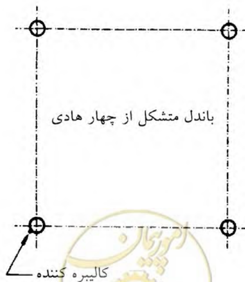
شکل ۳-۳۴: محل قرارگیری کالیبره‌کننده در یک باندل چهارتایی
