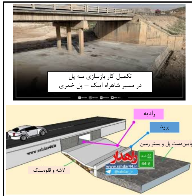
شکل ۳-۸۱- کاربرد رادیه و برید در پل‌ها و آبگذرهای راه و راه آهن ایران
