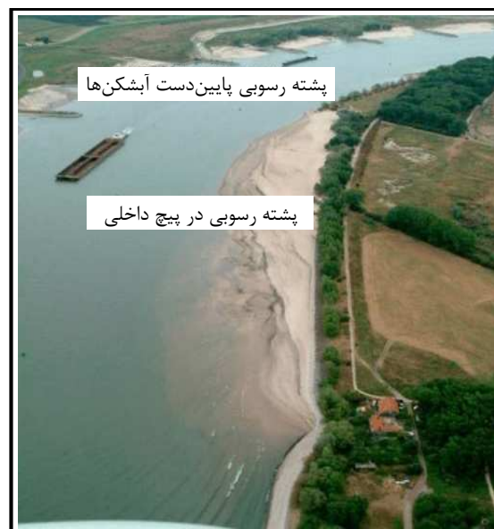
شکل ۳-۶۷- تشکیل پشته رسوبی در پیچ داخلی رودخانه
