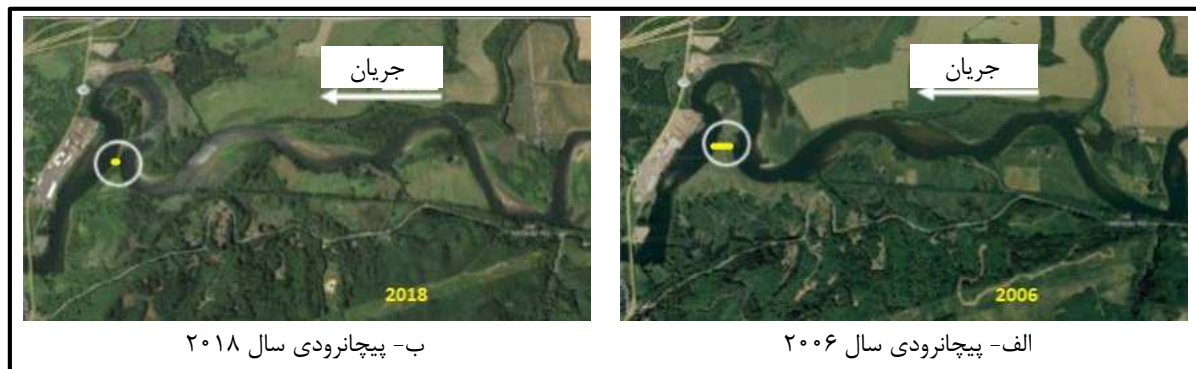
شکل ۳-۳۶- مهاجرت عرضی پیچ‌های یک رودخانه پیچانرودی
