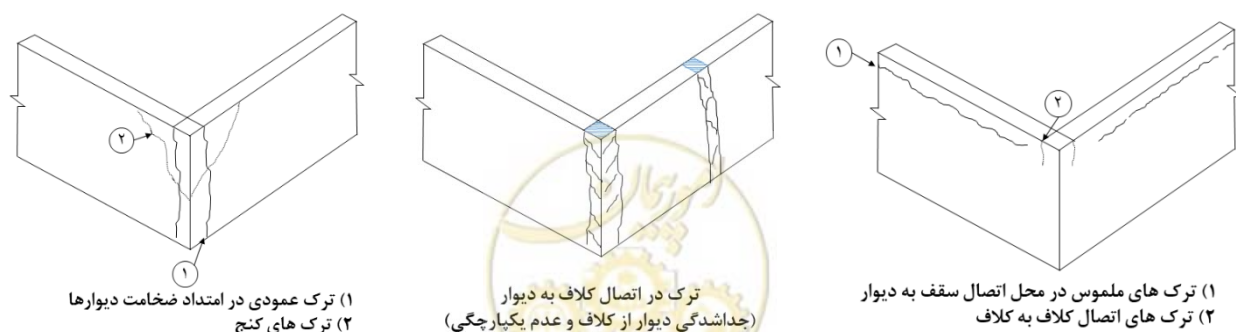
شکل (۱-۳): متداول‌ترین محل ترک‌ها در دیوار بنایی
