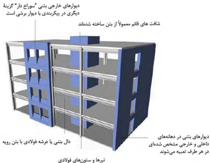
شکل 9-1- قابهای فولادی با دیوارهای برشی بتنی
