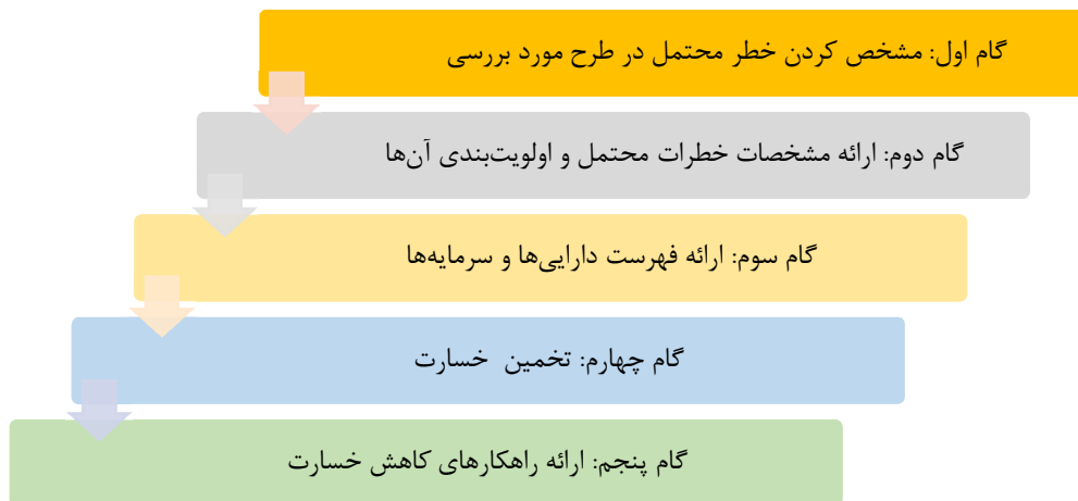
شکل ۳-۱۱- نمودار انجام مراحل تحلیل خطرپذیری در نرم‌افزار HAZUS - MH
