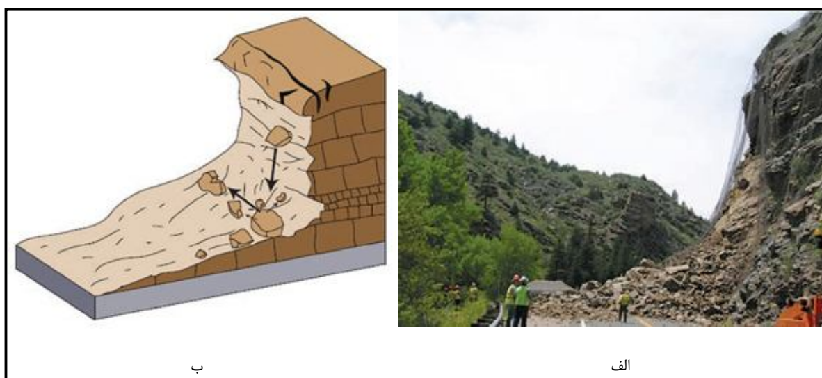
شکل ۱-۸- الف- تصویری شماتیک از ریزش، ب- سنگ افت/ سنگ لغزش که در نزدیکی دره کلیر کریک، کلرادو آمریکا در سال ۲۰۰۵ رخ داد. (عکس از سازمان زمین‌شناسی کلرادو) [۱۳]
