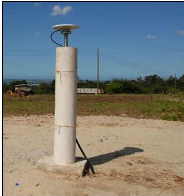
شکل ۲-۳۳- نمونه از ایستگاه GPS با ساختمان پیلار
