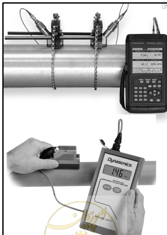
شکل ۷-۵- نمونه‌هایی از جریان‌سنج‌های فراصوتی قابل حمل (بالا) زمان-گذر و (پایین) داپلر
