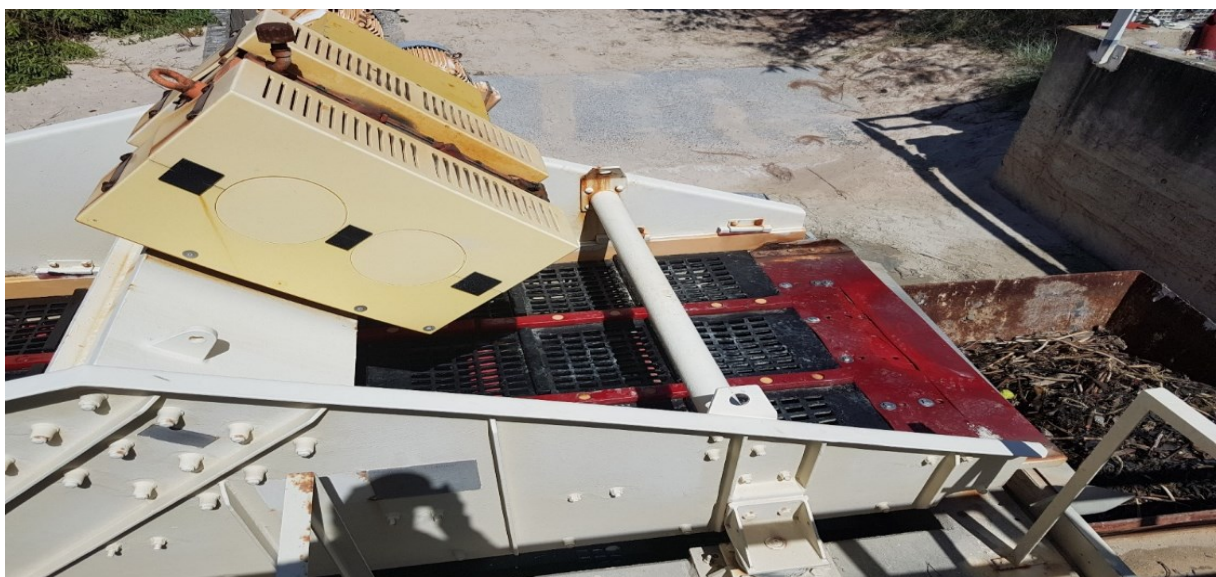
شکل ۶-۱- تجهیزات آشغالگیر در سیستم گذردهی رسوب رودخانه توئید
