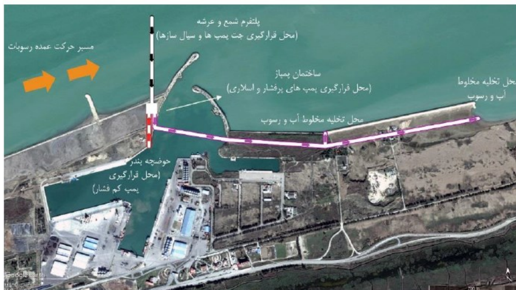
شکل پ.۴-۲: سیستم گذردهی رسوب بندر امیرآباد و جانمایی بخش های مختلف آن
