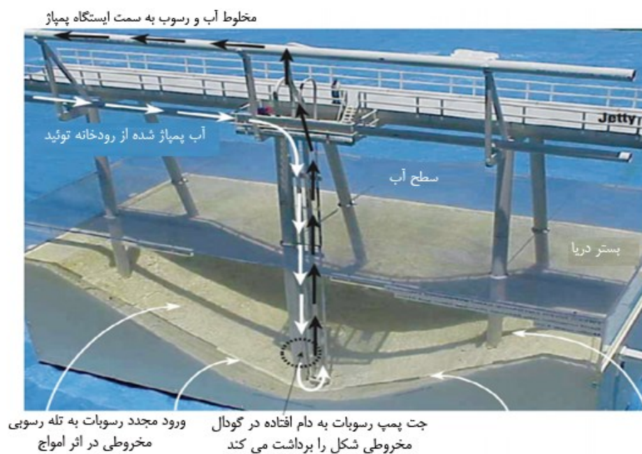
شکل ۱-۴- شمایی از نحوه عملکرد همزمان سیستم های سیال ساز و جت پمپ در سیستم گذردهی رسوب رودخانه تونید [۱]
