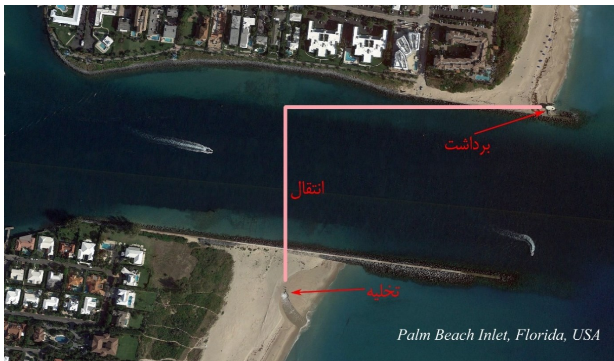
شکل ۲-۱- بخش‌های سه گانه سیستم گذردهی رسوب
