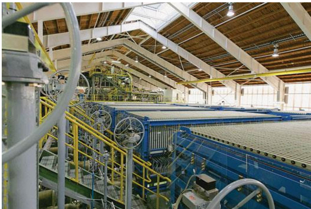
شکل ۱-۴: تاسیسات الکترولیز کلر-قلیایی نمونه با ظرفیت تولید سالیانه ۲۳۷ هزار تن سدیم هیدروکسید و ۲۱۰ هزار تن کلر
