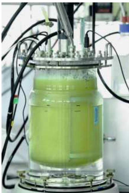
شکل ۳-۴: نمایی از یک راکتور زیستی نمونه برای متاناسیون بیولوژیکی
