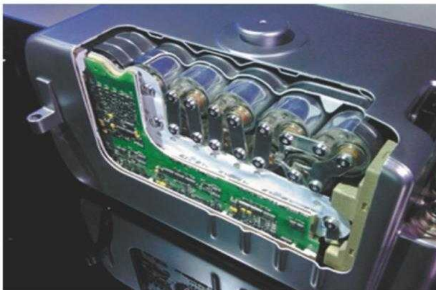
شکل ۱-۳۱: باتری لیتیوم یونی با طراحی بلوکی
