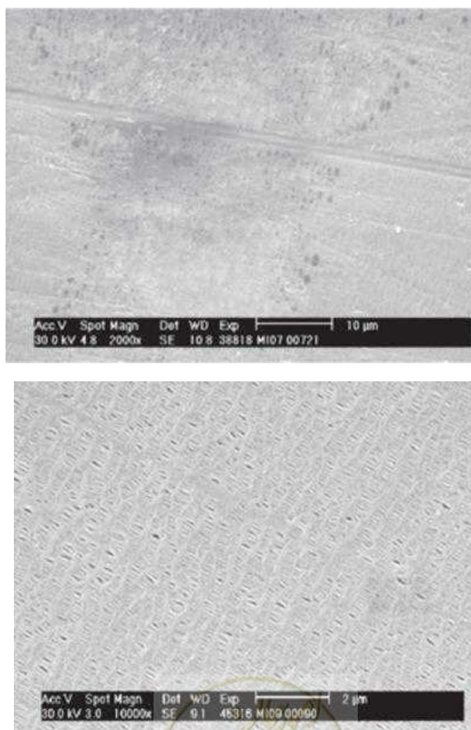
شکل ۱-۲۳: غشای خشک، (بالا) SEM کلی، (پایین) SEM با جزئیات بیشتر
