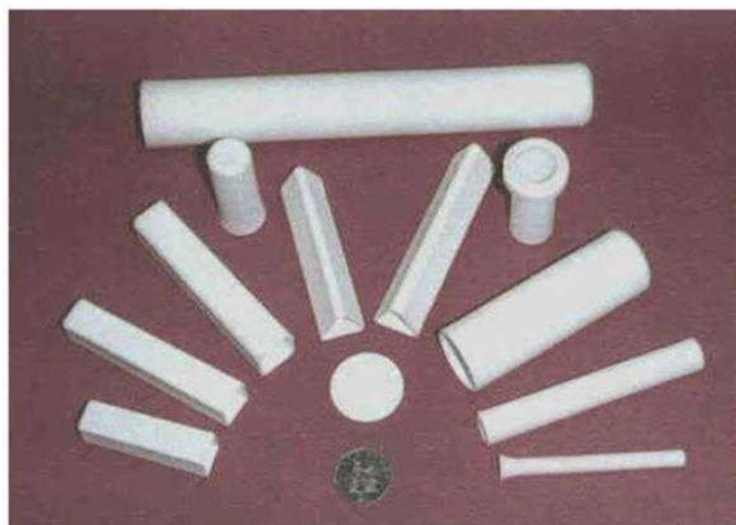
شکل ۵-۲: نمونه‌هایی از الکترولیت‌های جامد سرامیکی
