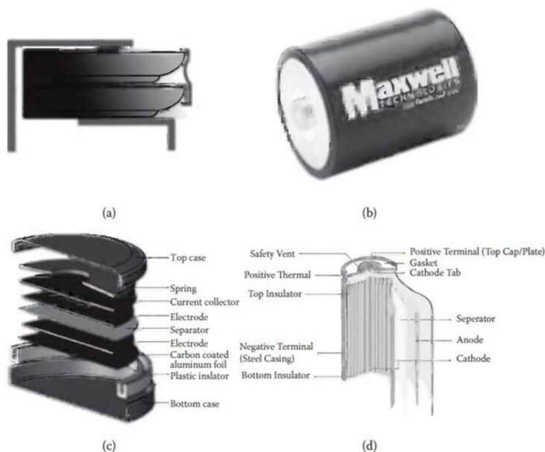
شکل ۱-۴-۲-۵-۱: (a) تصویر یک استک دو دکمه‌ای تولید شده به وسیله بسته‌بندی انقباضی (b) سلول رولی ساخته شده فلزی (c) سلول دکمه‌ای و (d) طراحی‌های سلول رولی برای سوپرکازن‌ها و باتری‌ها
