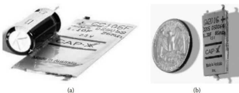
شکل ۸۵-۱: سلول کیسه‌ای (CAP-XX © EC) ساخته شده از کربن فعال و الکترولیت آلی. (a) تک سلول ۲/۵ ولت. (b) دو سلول استک با اتصالات کوتاه برای فراهم نمودن ۵ ولت
