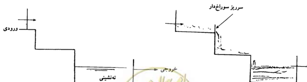
شکل ۱-۴ - روش هوادهی آبشاری پله‌ای
