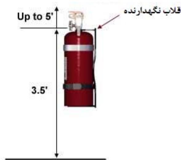
شکل ۵-۱۰- نحوه قرارگیری خاموش کننده در ارتفاع
