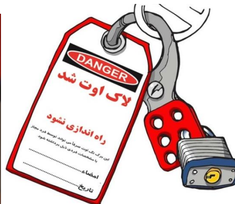
شکل ۵-۸- نمونه ای از برچسب و قفل در سیستم LOTO - قفل و برچسب جهت ولو یا شیر صنعتی
