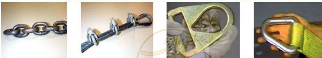
شکل ۱-۳- انواع اسلینگ/تسمه (از راست به چپ: تسمه برزنتی، تسمه با مش فلزی، سیم بکسل و زنجیر)
