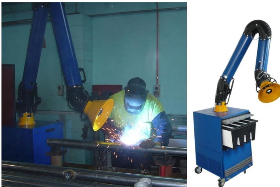
شکل ۱-۱۵- نمونه‌ای از هود موضعی متحرک جهت کنترل دود حاصل از جوشکاری
