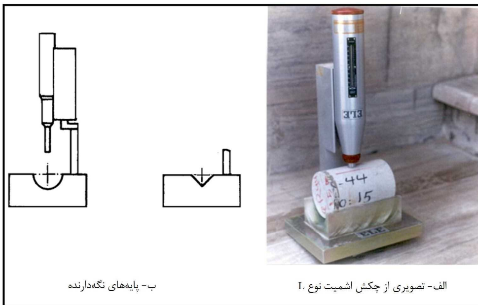
شکل ۲-۱۱- تصویری از چکش اشمیت نوع L و پایه‌های نگه‌دارنده
