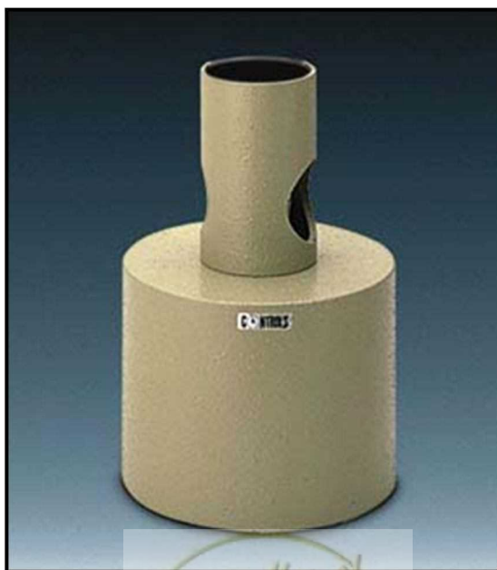
شکل ۲-۱۲- سندان فولادی واسنجی چکش اشمیت
