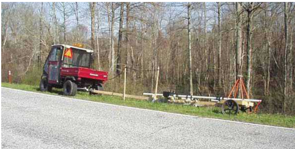
شکل (۴-۱۱) سیستم Em31-3 در حال انجام عملیات برداشت
