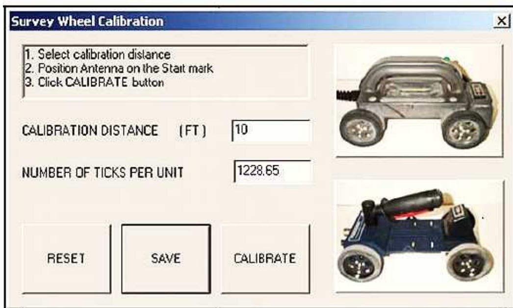
شکل (۴-۲۳) نمایی از تنظیم دستگاه برای کالیبراسیون مسافت سنج
