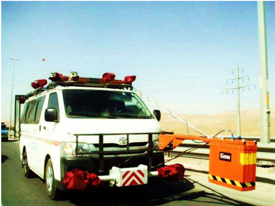
شکل (۴-۱۴) خودروی ون، در حال برداشت داده های GPR در استان فارس
