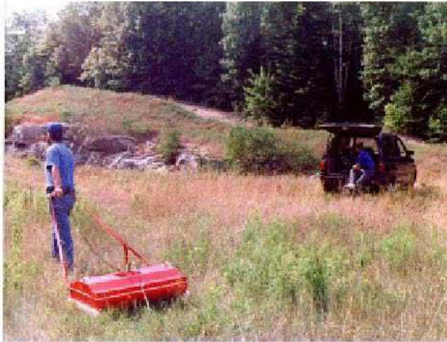
شکل (۳-۳۰) تیم برداشت و تجهیزات برداشت با آنتن‌های زمینی برای برداشت عمق‌های بیشتر
