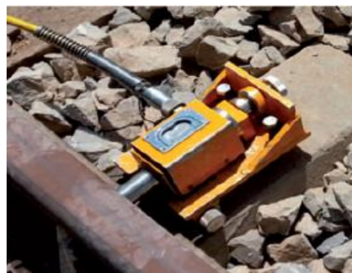
الف) جک هیدرولیکی بارگذاری
