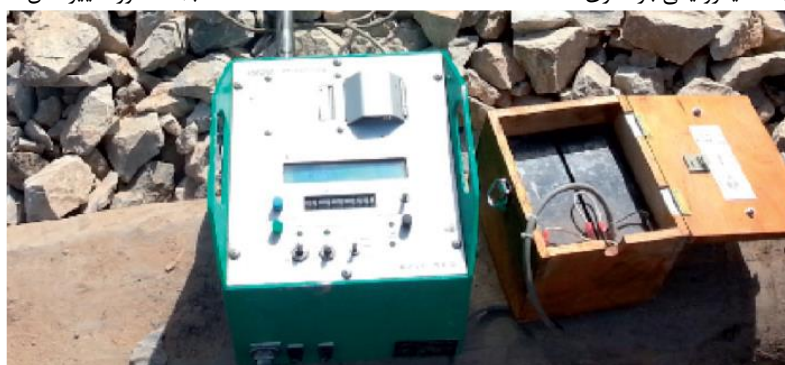
ج) دستگاه ثبت خودکار مقدار نیرو و جابجایی
