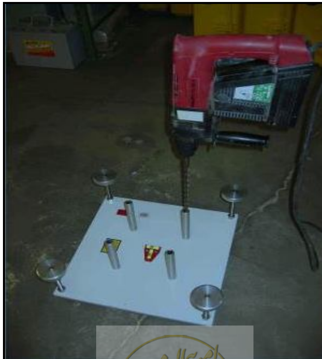
شکل ۲-۴۰- شابلن جهت دریل کاری موقعیت صحیح
