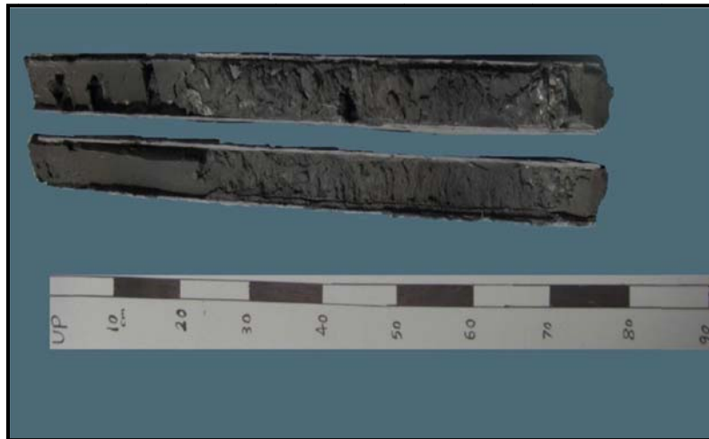
شکل ۳-۲۲- نمونه مغزه تقسیم شده به وسیله طبقه فولادی
