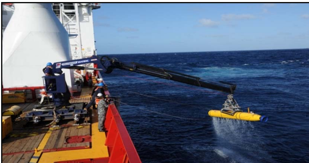
شکل ۴-۲۴- بازیابی ربات و انتقال به عرشه
