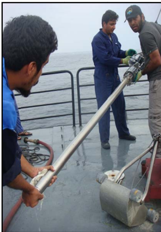
شکل ۲-۱۰- انتقال مغزه گیر به عرشه کشتی
