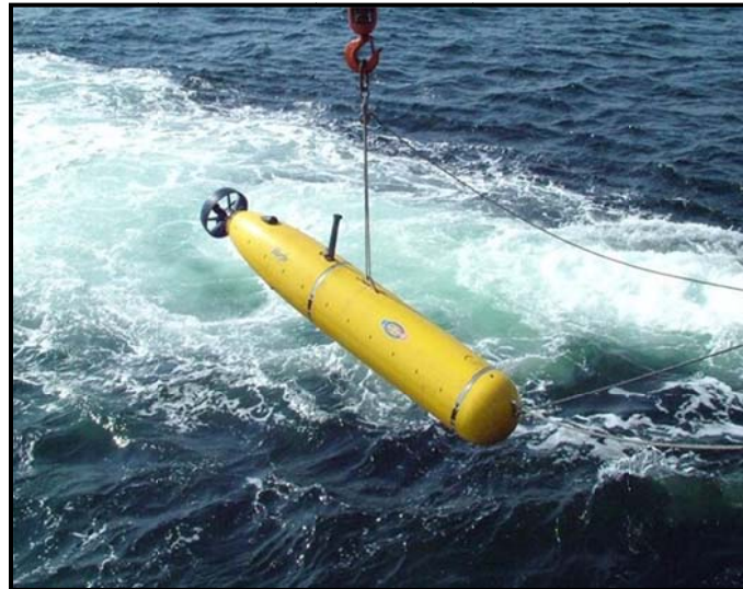
شکل ۴-۱۹- نمونه‌ای از ربات زیردریایی خودکار
