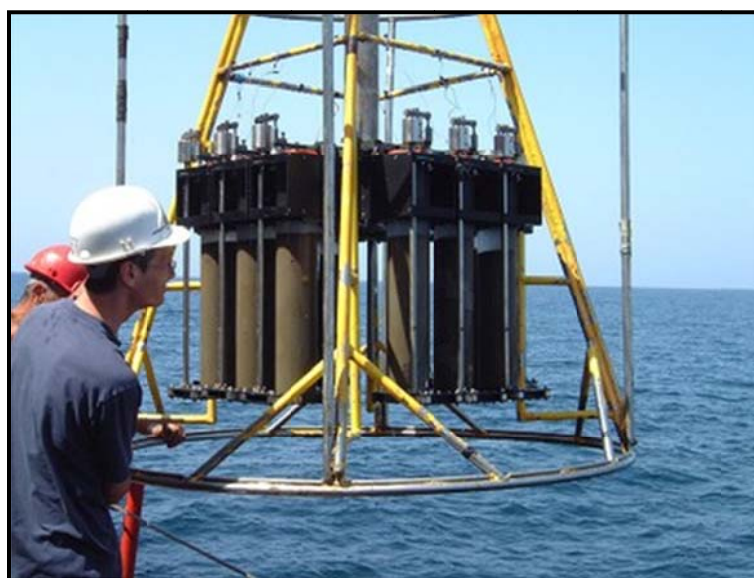
شکل ۲-۵- نمونه‌ای از مغزه‌گیر بزرگ
