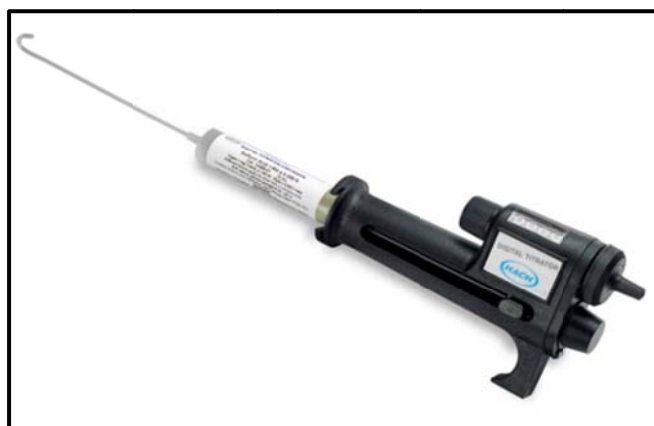
شکل ۴-۸- نمونه‌ای از تیترا تور دیجیتال
