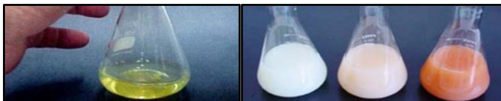
شکل ۴-۱- تغییر رنگ نمونه‌ی آب دریا پس از اضافه شدن کرومات پتاسیم (سمت چپ) و پس از اضافه شدن تدریجی نیترات نقره تا رسیدن به نقطه‌ی پایانی بارنگ آجری (سمت راست)
