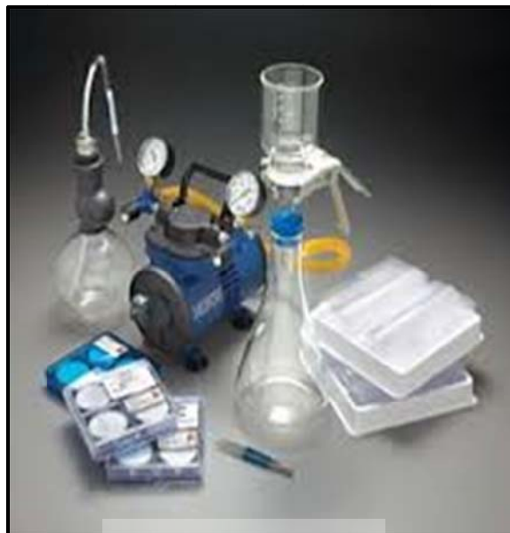
شکل ۳-۴- پمپ و ظروف برای فیلتراسیون
