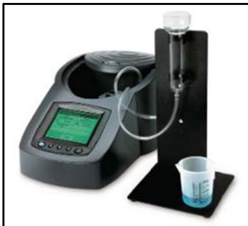
شکل ۵-۳- دستگاه فتومتر (DR/2500)
