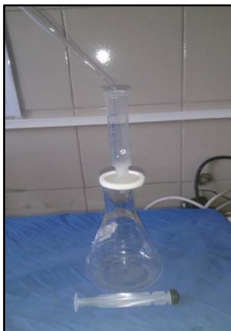
شکل پ.۱-۲- روش فیلتر کردن نمونه‌ها
