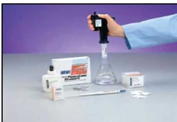
شکل ۴-۹- اندازه‌گیری قلیائیت به روش تیترا سیون
