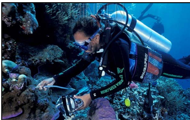
شکل ۳-۳- نحوه استفاده از فلورومتر زیردریایی Diving Pam
