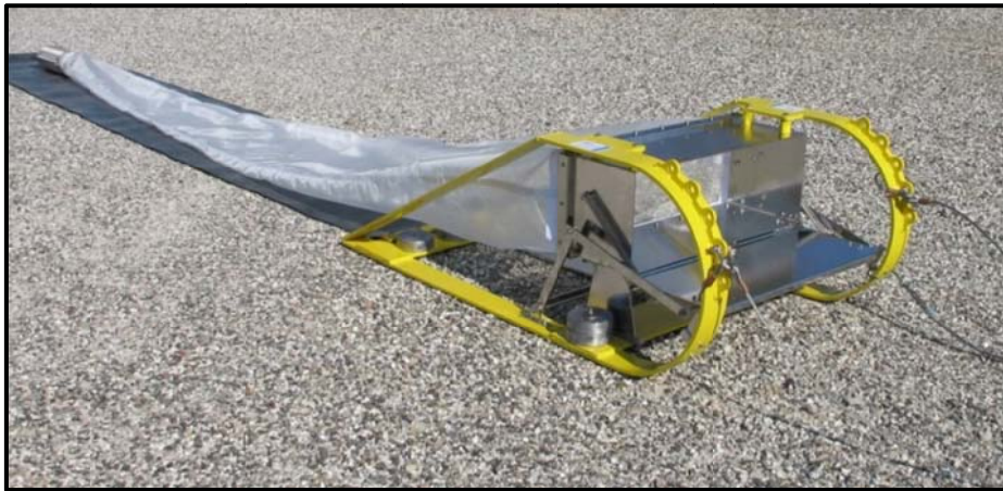
شکل ۶-۱۱- لایروب یا درجی که در بستر دریا کشیده می‌شود
