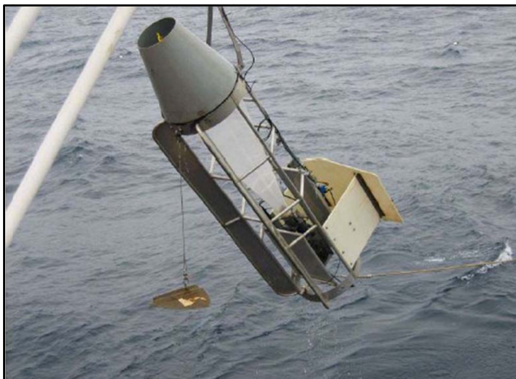
شکل ۵-۱۴- دستگاه ثبت پلانکتونی در پشت کشتی (تصویر از British Antarctic Survey)
