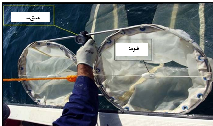
شکل ۵-۳- محل نصب عمق‌سنج دستی و فلومتر
