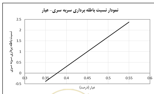
شکل پ-۲- منحنی نسبت باطله برداری سربه سری- عیار ماده معدنی
