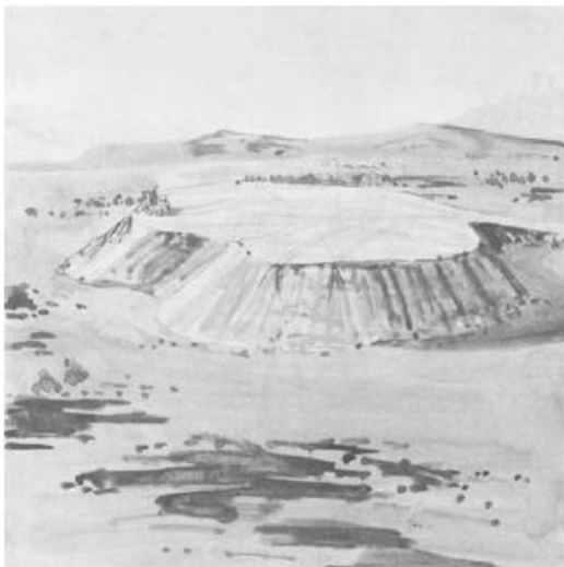
شکل ۴-۲- انباشتگاه پشته‌ای ۱ ایجاد شده در لایه‌های متوالی شکل ۴-۳- انباشتگاه پشته‌ای ایجاد شده در یک ارتفاع منفرد
