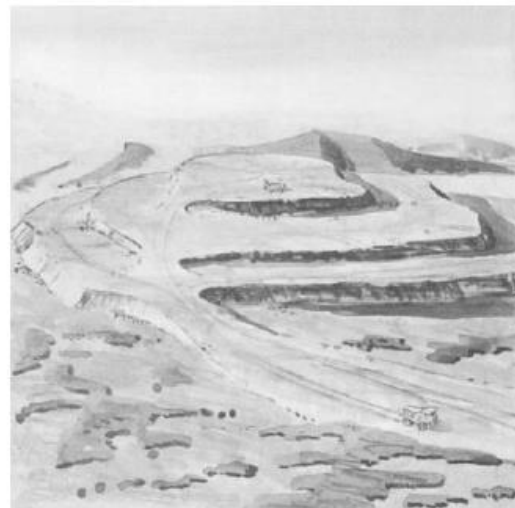
شکل ۴-۲- انباشتگاه پشته‌ای ۱ ایجاد شده در لایه‌های متوالی شکل ۴-۳- انباشتگاه پشته‌ای ایجاد شده در یک ارتفاع منفرد
