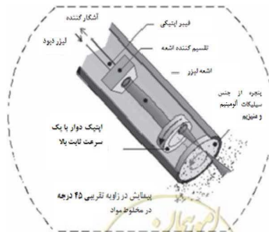
شکل ۱-۴- ابزار اندازه‌گیری طول وتری به روش FBRM
