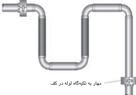
شکل 5-166- درز انبساطی بالاتر از کف
