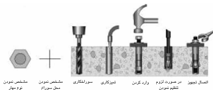
شکل 5-131- مراحل نصب مهارهای غیرچسبنده
