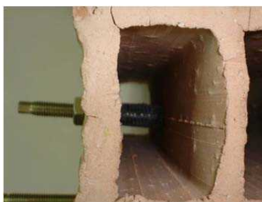
شکل 5-135- نمونه مهار چسبنده در آجر و بلوک مجوف
