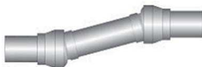
شکل 5-165- درز انبساطی دوپل سوکته
