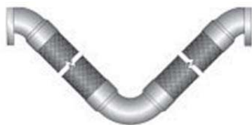
شکل 5-164- درز انبساطی شلنگ سیمی
