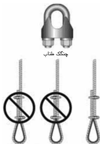
شکل 5-149- روش مناسب چنگک طناب سیمی
