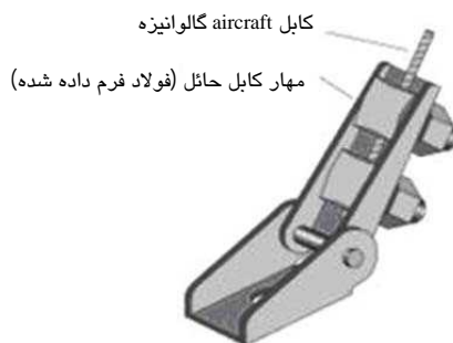
شکل 5-146- کابل متصل شده به سگدست با پیچ
