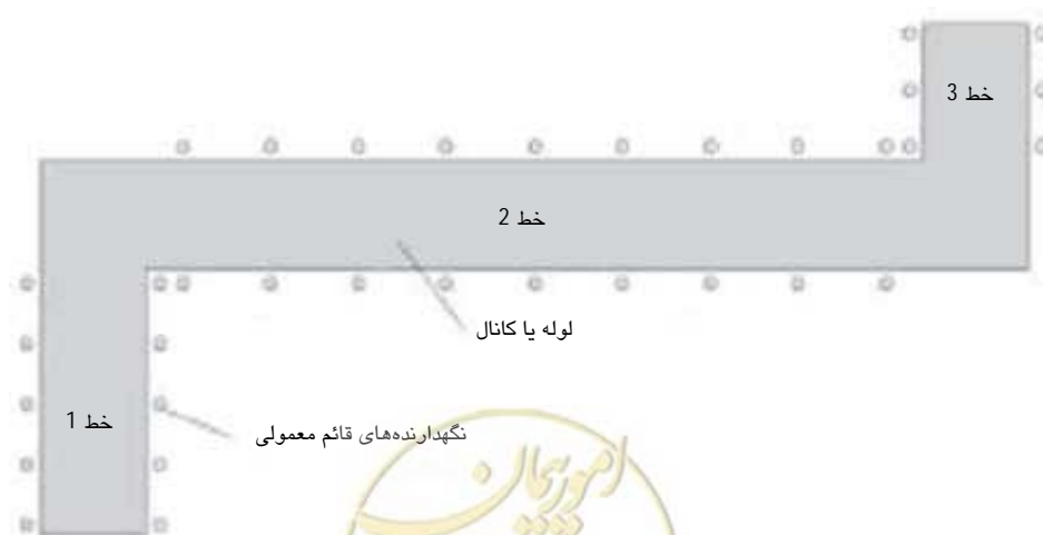
شکل 5-67- خطوط لوله با نگهدارنده‌های قائم معمولی
