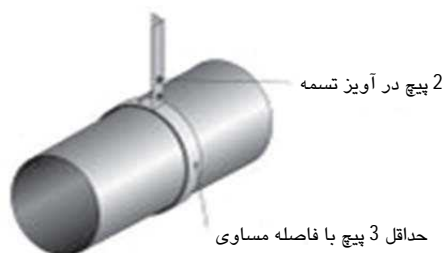
شکل 5-85- مهار تسمه‌ای برای کانال دایروی با مهاربندی فولادی
