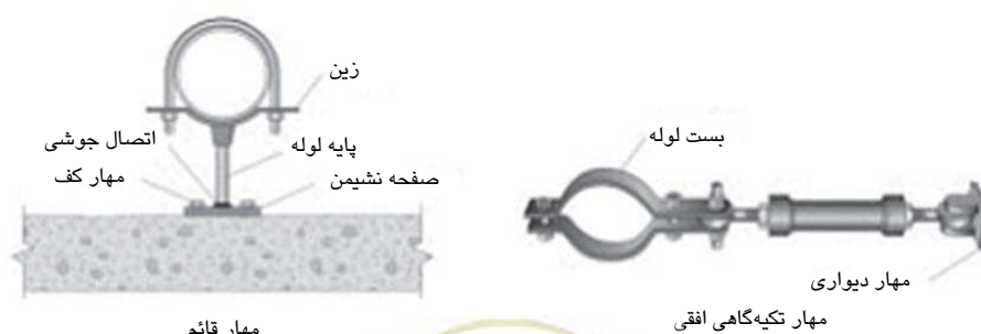
شکل 5-168- جزئیات مهاربندی لوله
