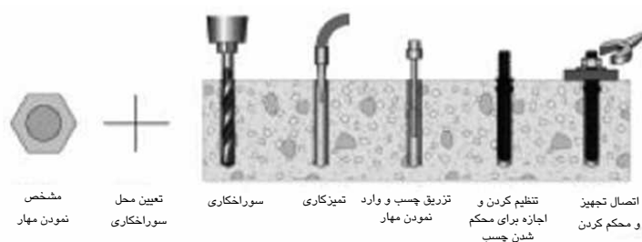
شکل 5-132- مراحل نصب مهارهای چسبنده
