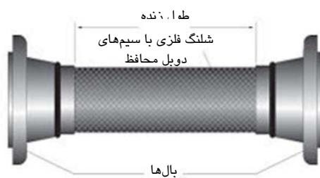
شکل 5-161- لوله از نوع شلنگ سیمی
