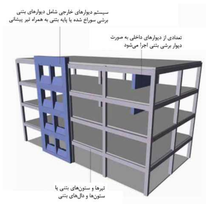
شکل 9-1- دیوار برشی بتنی با قاب باربر گرانشی
