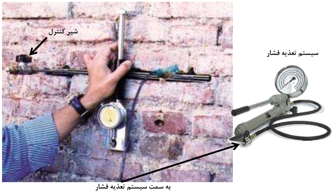
شکل 2-3- نحوه انجام آزمایش درجا برای تعیین مقاومت فشاری منشور آجری
