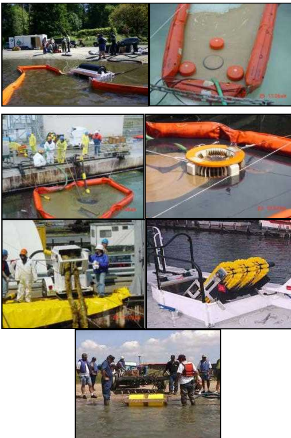
شکل پ. ۴-۵۵- انواع اسکیمرها و کاربرد آن‌ها
