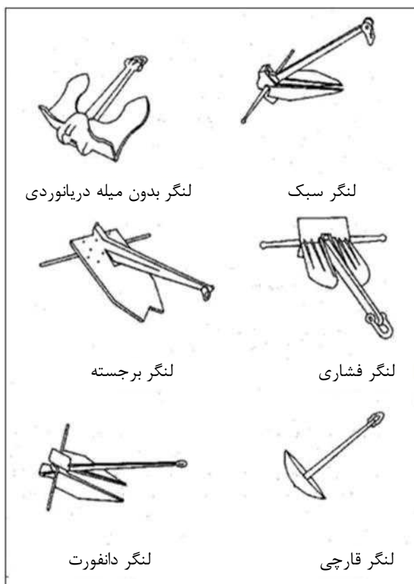
شکل پ. ۴-۴۸- انواع متفاوت از لنگرها برای نصب بوم‌ها در دریاچه‌ها به‌عنوان تکیه‌گاه
