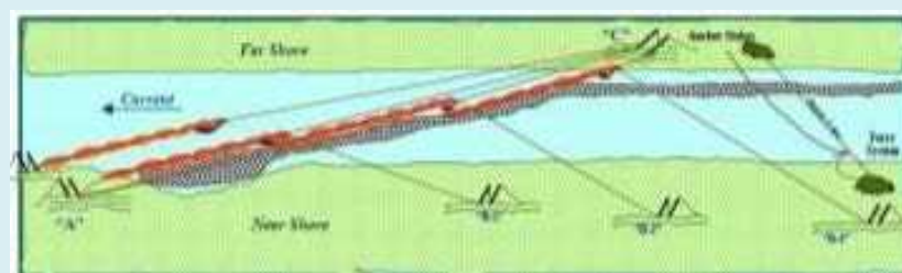
ادامه شکل پ.۴-۴۱- تکنیک بوم‌گذاری در آب رودخانه با جریان سریع (ساحل به ساحل)
