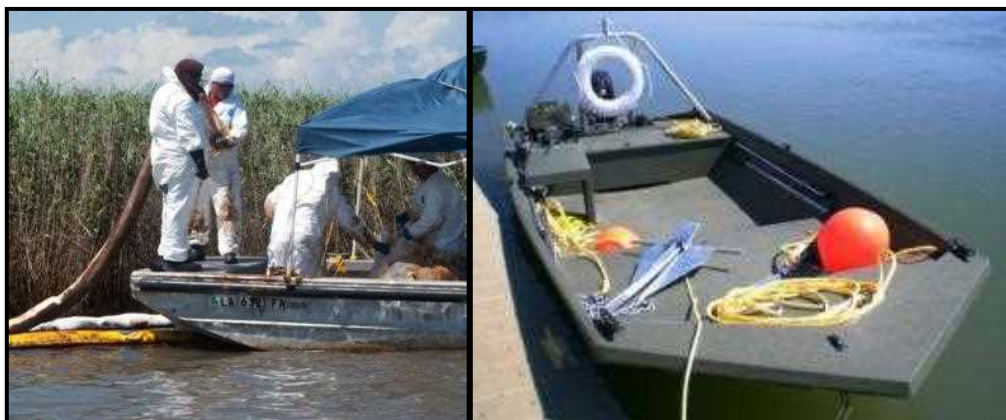
شکل پ.۴-۶- ابزارهای آماده به کار در داخل قایق‌های مخصوص برای افزایش سرعت عملیات مقابله
