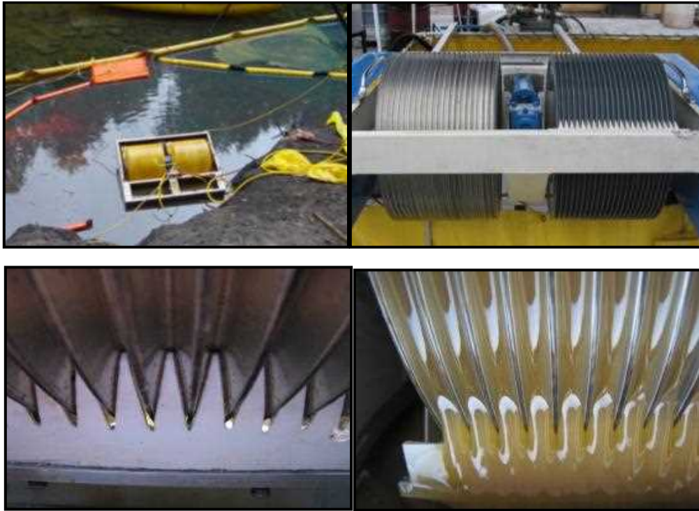
شکل پ.۴-۵۴- یکی نمونه از اسکیمر غلتکی و روش جدا کردن نفت توسط آن‌ها
