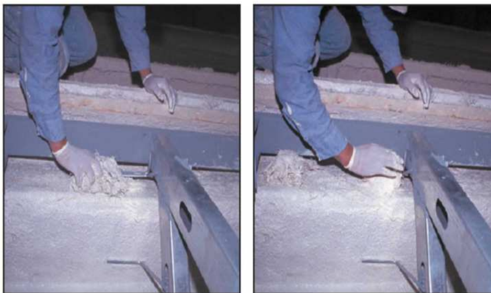
شکل ۶-۴۳- ساختن لایه‌های پیوندی
