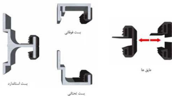
شکل ۷-۱۱- نصب درزپوش بر روی بست‌ها
