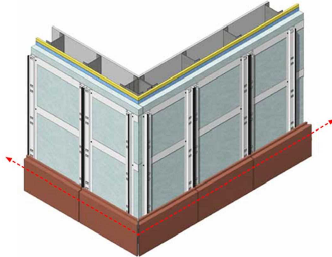
شکل ۷-۱۵- کنترل تراز بودن پنل‌ها
