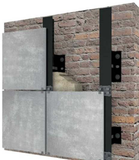
شکل ۷-۲۲- اجزای سیستم نصب نمایان
