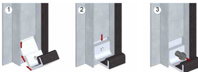
شکل ۷-۱۲- نحوه نصب بست‌ها بر روی ریل
