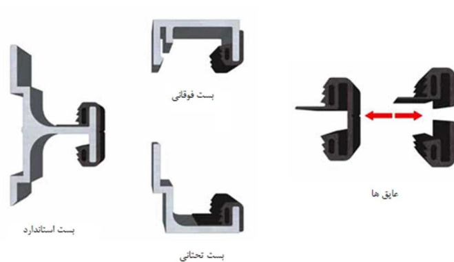
شکل ۷-۱۱- نصب درزپوش بر روی بست‌ها
