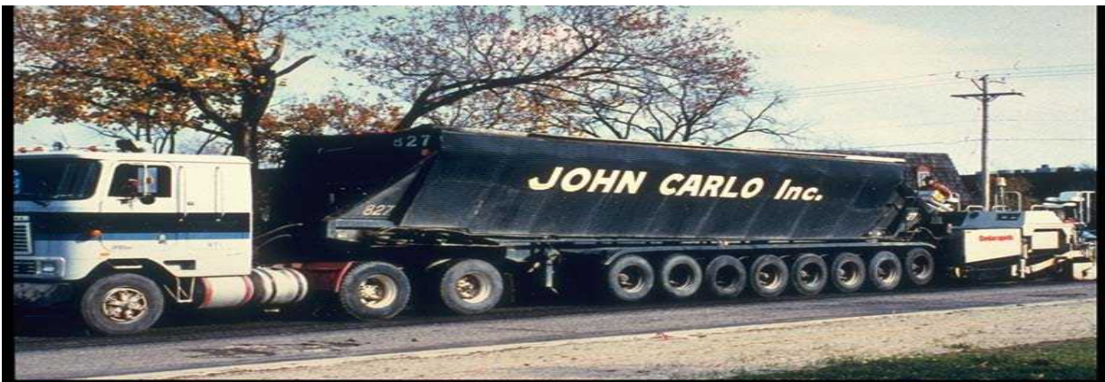
شکل ۳-۷- نمایشی از کامیون تخلیه کننده بار از عقب با استفاده از سیستم تسمه نقاله
