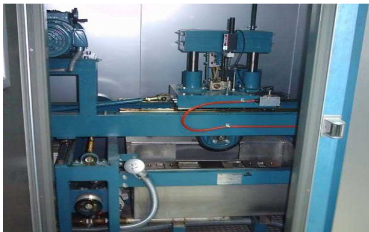
شکل ۲-۱۹- دستگاه شیارافتادگی ویل تراک‌هامبورگ برای آزمایش شیارافتادگی
