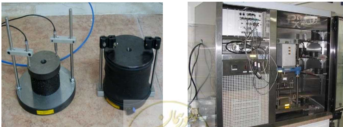
شکل ۲-۱۸- دستگاه UTM و محفظه نمونه برای آزمایش خزش
