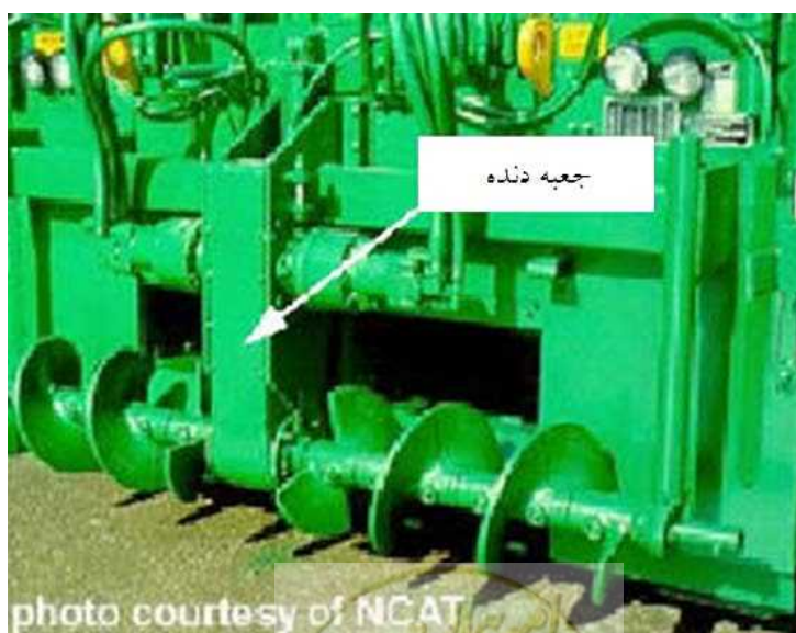
شکل ۳-۱۲- جعبه بخش آسفالت و تیغه مارپیچ فینیشر (نمونه با جعبه دنده تعبیه شده در وسط)
