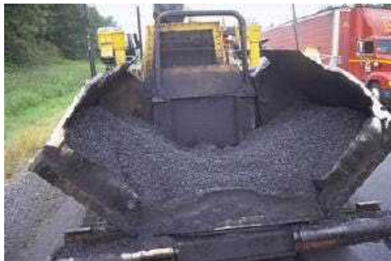
شکل ۳-۱۰- جداره‌های قیف فینیشر که به صورت شیب دار می‌باشند.
