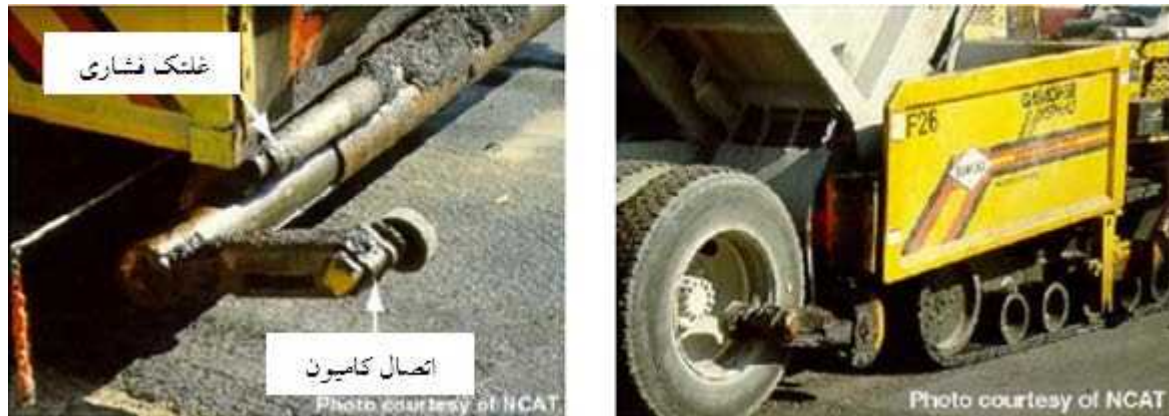
شکل ۳-۹- نمونه‌هایی از گلتک‌های فشاری دستگاه فینیشر و اتصال گیردار کامیون به فینیشر
