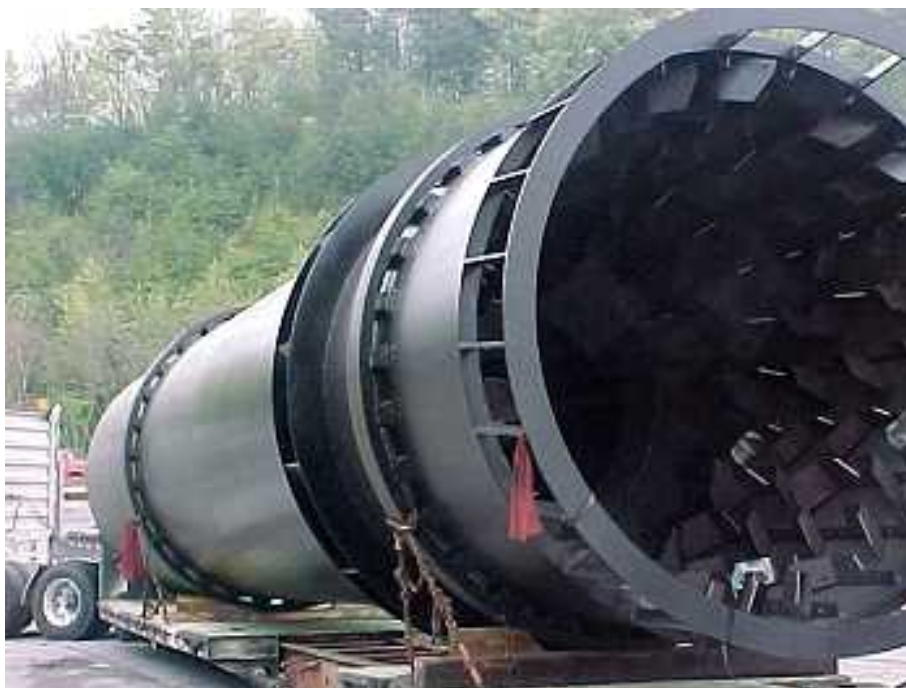
شکل ۳-۲- گردونه دوار کارخانه آسفالت جهت خشک کردن مصالح سنگی
