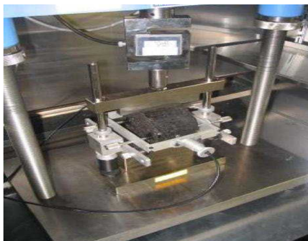
شکل ۲-۳۱- نحوه قرارگیری مغزه ۴ اینچی در دستگاه UTM
