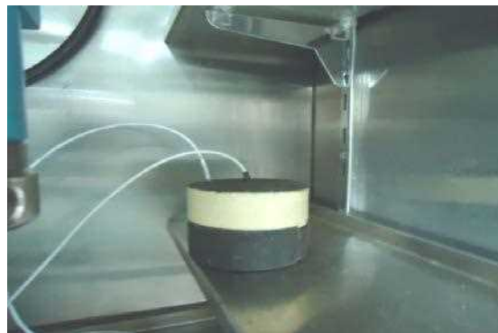
شکل ۲-۱۳- حسگرهای قرار گرفته در نمونه آزمایش خزش
