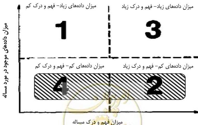
شکل ۱-۱- تقسیم‌بندی مسایل مهندسی بر اساس میزان اطلاعات پیرامون آن‌ها و درک و فهم از مساله
