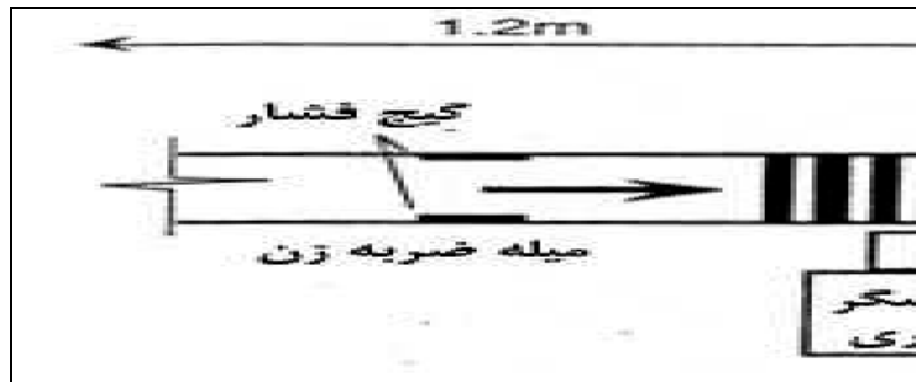
شکل ۹-۱- نمای کلی آزمایش میله فشار هاپکینسون
