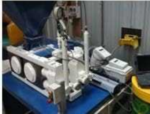
شکل ۱۴-۳-HPGR در مقیاس آزمایشگاهی
