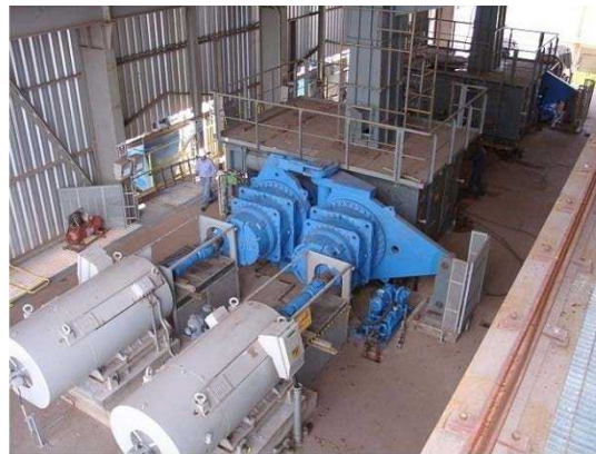
شکل ۱-۱۴- نمایی از دستگاه HPGR در کارخانه گندله‌سازی
