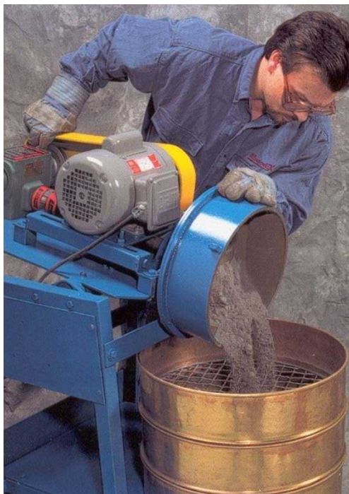
شکل ۶-۱- آسیای آزمایشگاهی مورد استفاده در تعیین شاخص توان نیمه‌خودشکن
