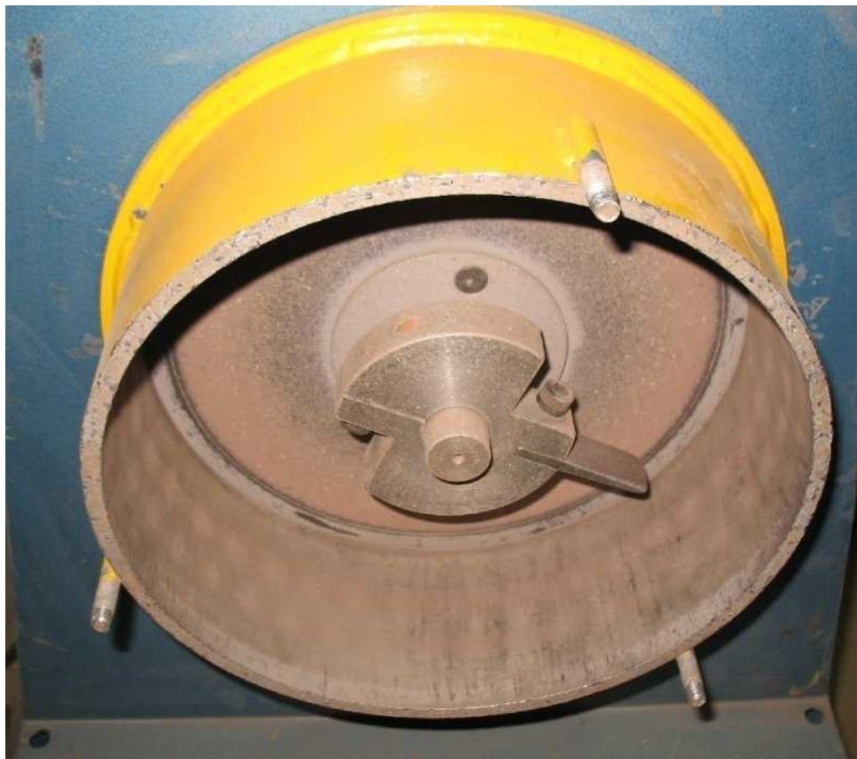
شکل ۵-۱- آسیای مورد استفاده در آزمایش تعیین ساینده‌گی کانسنگ
