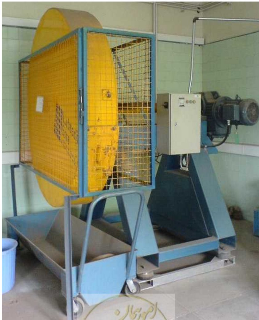
شکل ۷-۱- دستگاه تست استحکام کانسنگ معروف به آسیای یک فوت در شش فوت
