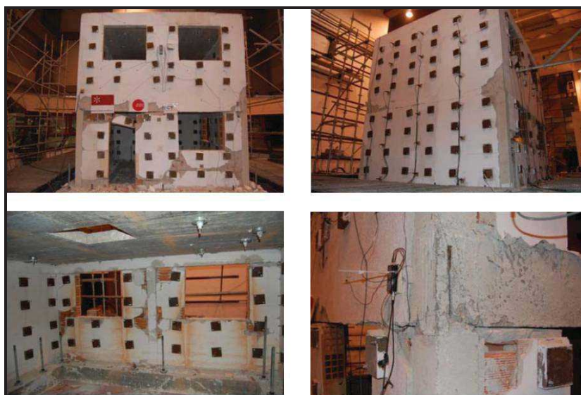
شکل 1-14- حفظ پایداری خارج از صفحه میانقاب‌های تک لایه به واسطه استفاده از میلگرد بستر [21]
