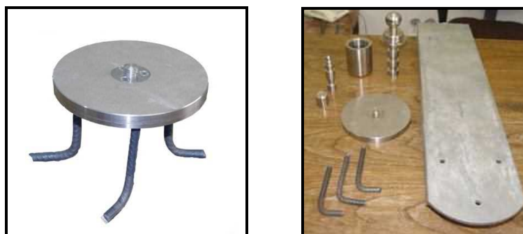
شکل ۱۰-۵- شاخص نقاط پیمایش (سمت راست) و نقاط پیلار (سمت چپ) (۱۱، ۱۲)
