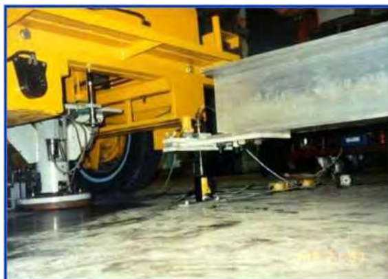
شکل ۲۴- تجهیزات کالیبراسیون دستگاه FWD
