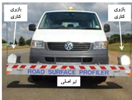
شکل ۷۲- ساختار دستگاه RSP
