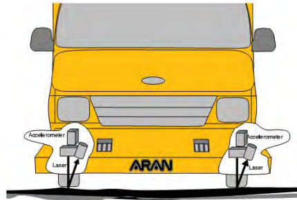
شکل ۷۹- سامانه لیزری در قسمت جلوی دستگاه برای تعیین پروفیل طولی راه
