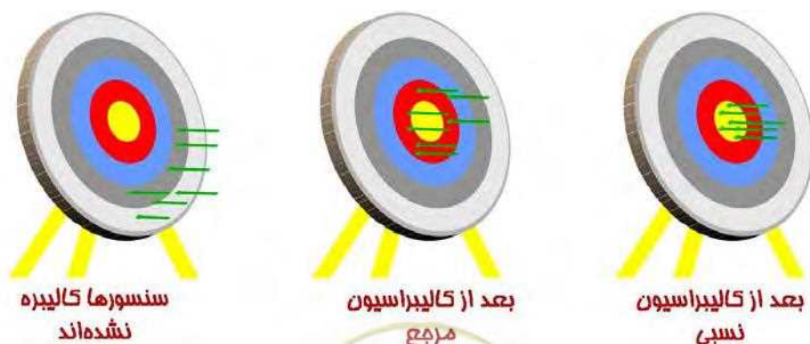
شکل ۲۱- تصویر شماتیک از دقت کالیبراسیون‌ها
