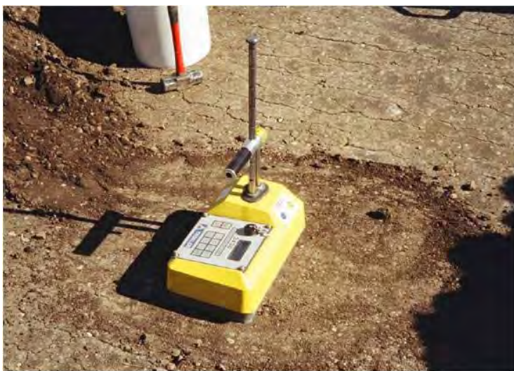
شکل ۴۰- دستگاه هسته‌ای تراکسلر
