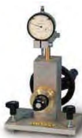
شکل ۶- دستگاه کالیبراسیون تیر بنکلمن
