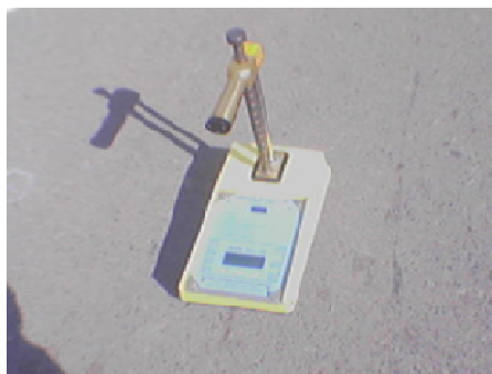
شکل ۴۷- دانسیته‌سنج هسته‌ای هنگام کالیبراسیون
