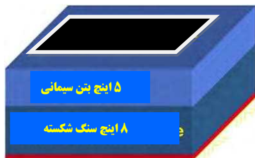
شکل ۲۲- ساختار صفحه ایزوله
