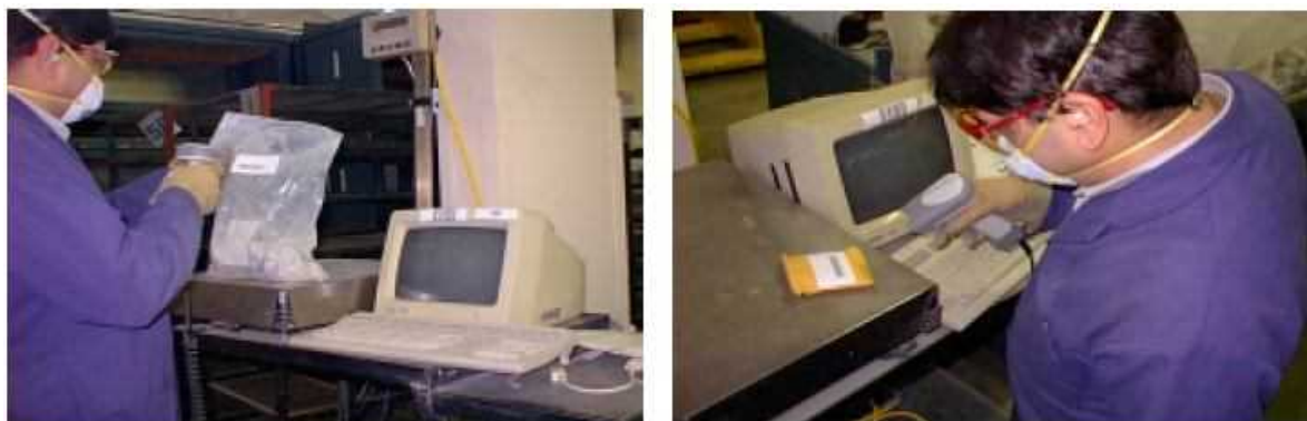
شکل ۲-۵- برچسب و اسکن آن به هنگام پذیرش نمونه
