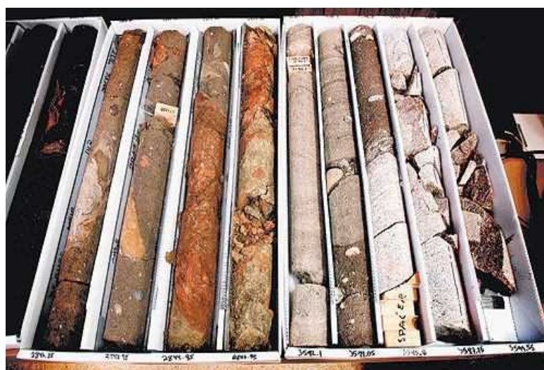
شکل ۲-۲- نمونه‌ای از جعبه‌های مورد استفاده برای نگهداری نمونه‌ها
