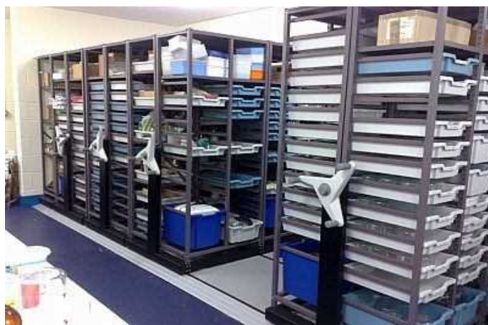
شکل ۳-۲- نمایی از قفسه‌های متحرک برای نگهداری نمونه‌های با حجم کم تا متوسط
