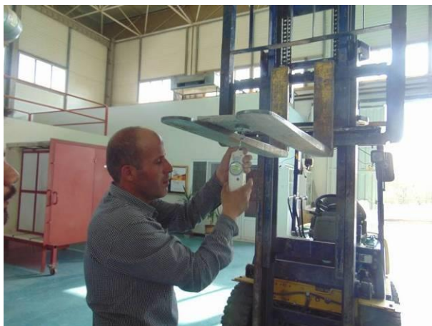
شکل ۵-۲- نحوه انجام آزمون تعیین مقاومت چسبندگی
