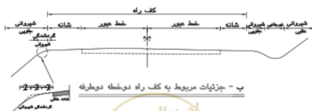
شکل ۶-۲- اجزای مقطع عرضی در راههای دو خطه و چهار خطه
