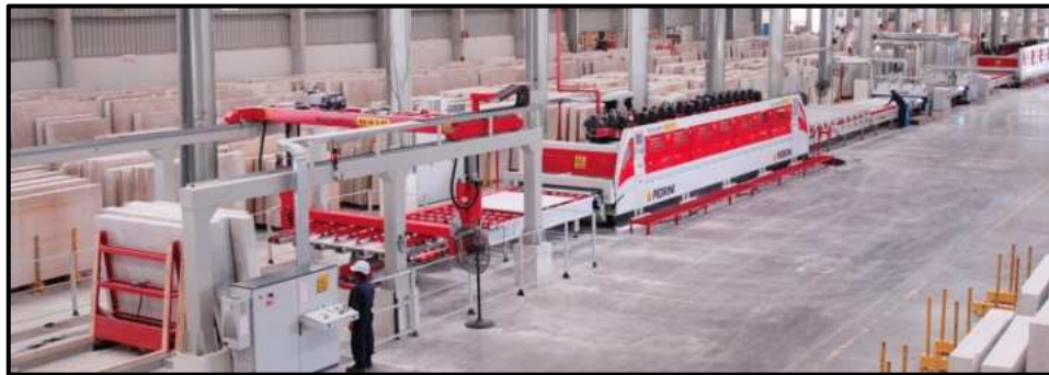
شکل ۳-۳- فرآیند تولید سنگ‌های تزئینی و نمای نرم در یک واحد سنگبری
