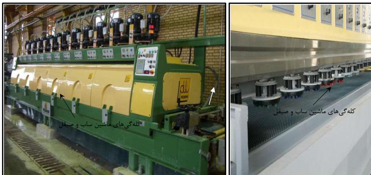
شکل ۲-۹- دستگاه ساب و صیقل تمام خودکار با ۱۲ کله ساینده
