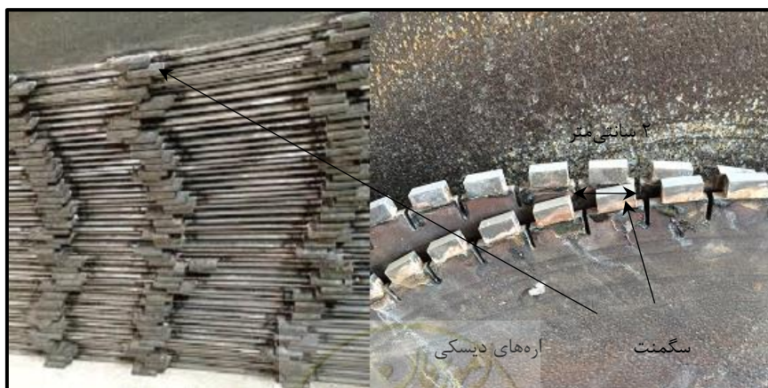
شکل ۲-۱۸- سگمنت روی تیغه اره و دیسک
