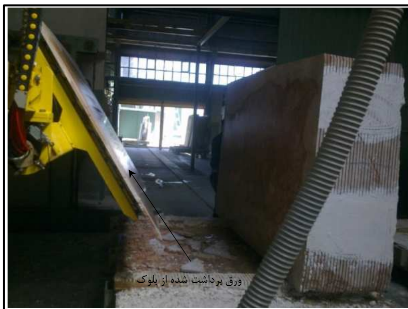
شکل ۲-۱۴- جدا کردن ورق‌های بریده شده با دستگاه مکش
