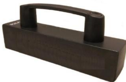
شکل ۱- بلوک وزنه استاندارد ۴/۵ کیلوگرم
