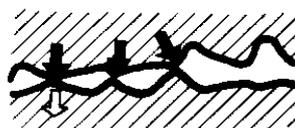
در حالتی که بین دو سنگ، ملات قرار گرفته باشد، نیروها از طریق ملات، به طور متعادلی پخش و منتقل می‌شوند.
