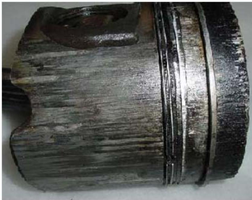
شکل شماره (۶-۸) - خرابی سیستم سوخت رسانی و گداخته و حل شدن پیستون در این حالت نازل‌های انژکتور براساس فشار پاشش استاندارد، تست و تنظیم می‌گردد و از سیستم سوخت رسانی رفع عیب بعمل می‌آید. نمونه ای از آنالیز روغن ناشی از خرابی سیستم سوخت در نمودار شماره ۶-۶ نشان داده شده است.
