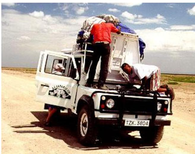
شکل شماره (۱-۴) - استفاده نامناسب از روش تعمیر بعد از خرابی در ماشین آلاتی که دور از مراکز تعمیر و سرویس فنی فعالیت دارند منجر به توقف طولانی ماشین برای انجام تعمیرات می‌گردد.
