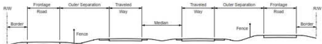
شکل ۶-۱۶- نمونه‌ای از مقطع عرضی راه شریانی جداشده با احتساب راه‌های جانبی
