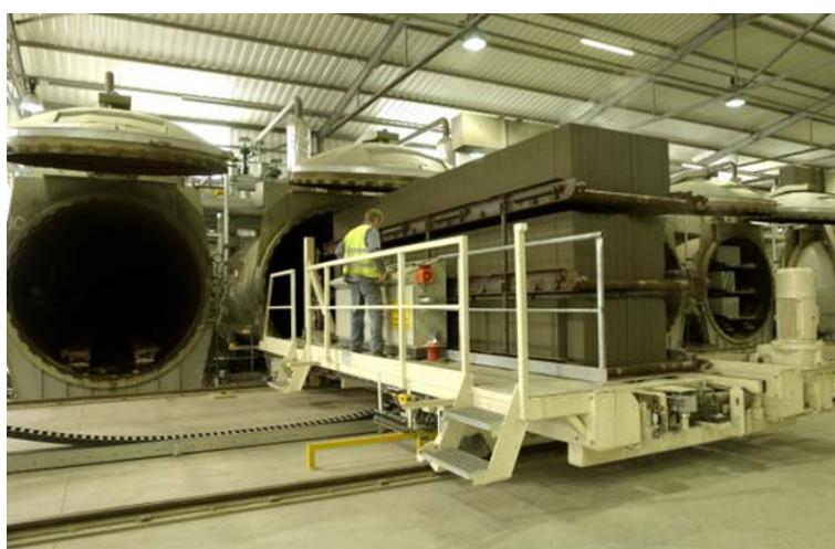
شکل ۱-۶- بلوک‌های خام به درون اتوکلاو تغذیه می‌شوند
