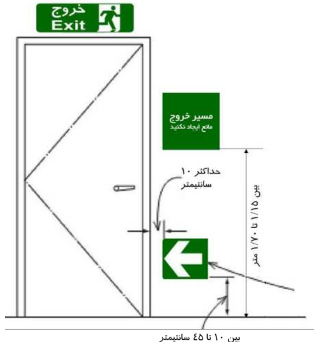
شکل ۱۵-۱- فواصل نصب تابلو روی دیوار
