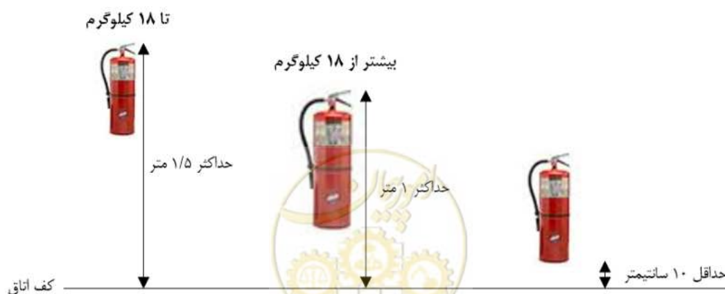
شکل ۹-۶- ارتفاع نصب خاموش‌کننده دستی از کف
