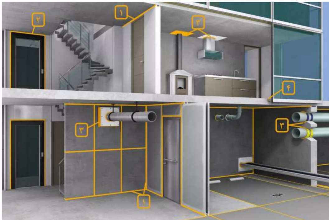
شکل ۱- ۱۷- مثال‌هایی از درزبندی آتش
