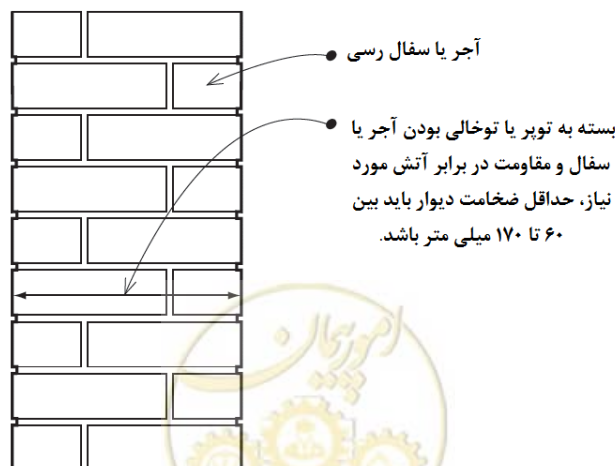
شکل ۸-۹- دیوارهای بنایی آجری یا سفالی رسی مقاوم در برابر آتش
