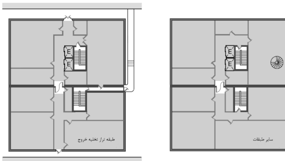
شکل ۶-۶- دسترس خروج (قسمت‌های سایه خورده دسترس خروج محسوب می‌شوند)
