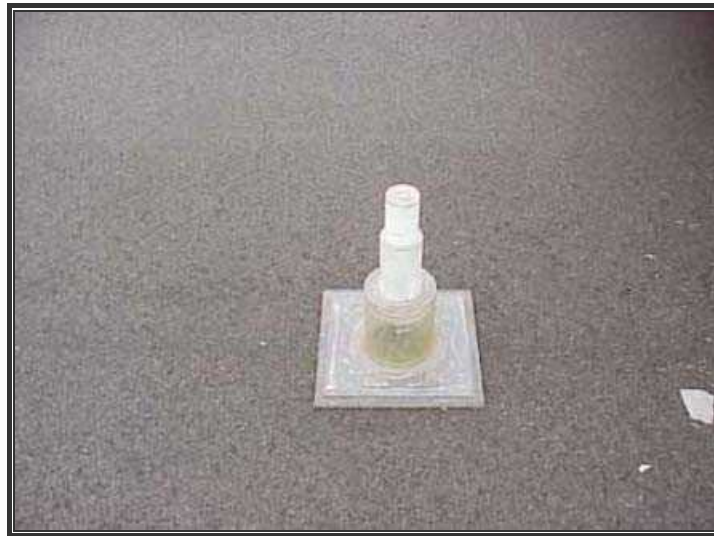
شکل پ ۱-۱- نمای دستگاه نفوذسنج میدانی NCAT
