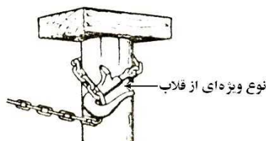
شکل ۳-۵- نحوه‌ی به هم گره زدن زنجیر و قلاب به منظور آزادسازی پایه‌های چوبی
